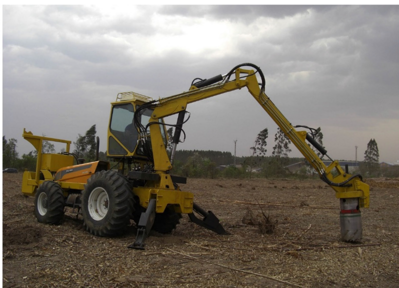
Figura 1. Desenho da serra tubular e seus componentes (Fonte: Engenharia Motocana) e foto do equipamento montado.
