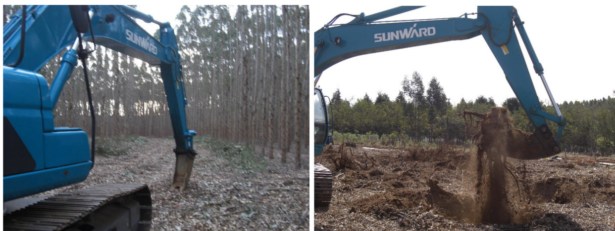
Figura 3. Destocador montado na escavadora hidráulica em operação.
