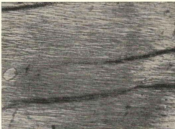
Fif. 2 — Ortoclásio micropertítico, mostrando o intercrescimento albitico do tipo cordel (string type), com bulbos de albita elíticos, fusiformes, alinhados segundo (010). Nícoes cruzados. 80 \times .
