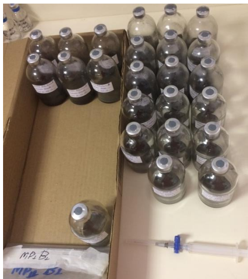
Figura 1. Amostras acondicionadas em vials lacrados e com atmosfera de nitrogênio (N 2 ).
