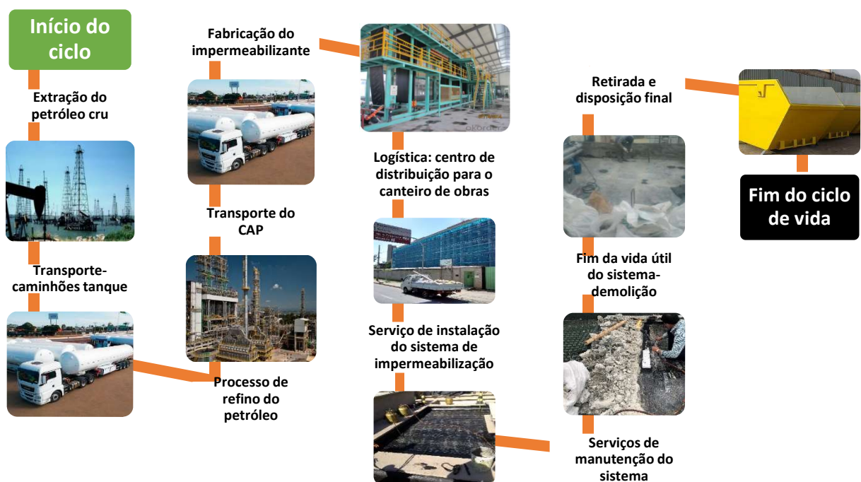
Figura 1- Representação esquemática do ciclo de vida, do berço ao túmulo, de sistema de impermeabilização composto por manta asfáltica
