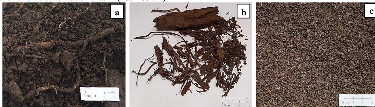
Figura 2. Amostras de turfa após coleta (a) e material retido (b) e passante (c) na peneira de 2,00 mm.
