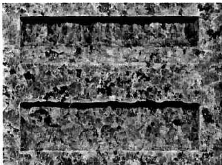
Figura 37 — Detalhe da gravação de ranhuras múltiplas feitas com uma velocidade de 10 mm/s e um espaçamento na primeira gravação de 0,25 mm e na segunda de 0,5 mm.
