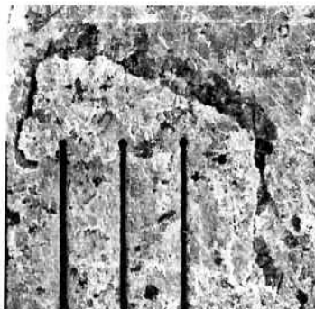
Figura 55 — Lasca no Granito Vermelho Capão Bonito.
