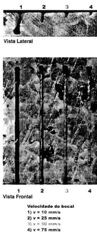
Figura 5 — Vista lateral e vista frontal das peças ensaiadas com altura do bocal de 3 mm, velocidades variadas e pressão de 70 MPa.
