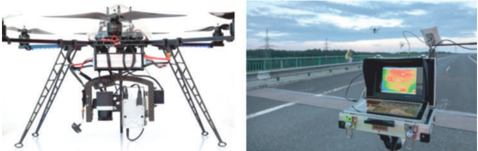
Figura 24 Mapeamento Térmico área urbana (estradas e pontes). Fonte: Droneng 32 (2017).
