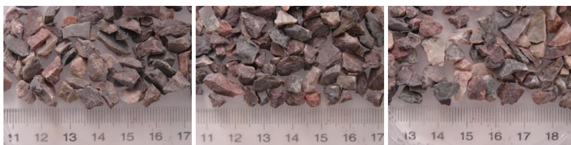
Figura 3. Amostra de minério silicatado de zinco de 6,3 mm a 4 mm. Da esquerda para direita, alimentação, concentrado e rejeito.
