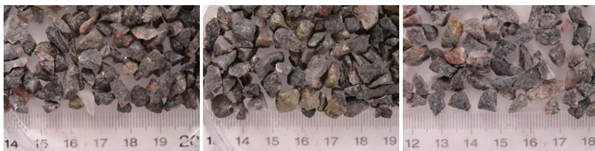
Figura 2. Amostra de minério sulfetado de cobre de 6,3 mm a 4 mm. Da esquerda para direita, alimentação, concentrado e rejeito.
