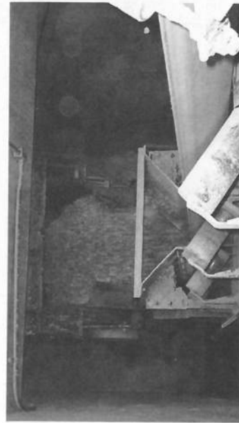
Fig. 4.16 Calha vibratória retomando brita estocada em pilha
