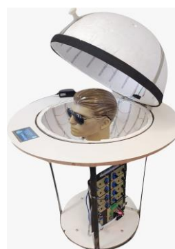
Figura 1: Protótipo para medição de proteção das armações de óculos de sol.
