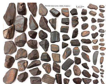
Figura 6 - Pebbles após 150 minutos de moagem Fonte: Arquivo pessoal
