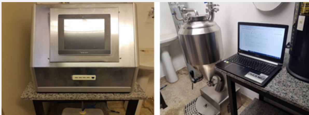
Espectrômetro para emissão e leitura dos sinais infravermelhos (esquerda) e tanques de fabricação de cerveja ao lado do computador com o programa de I. A. (direita)
