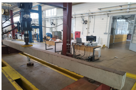
Figura 1: Ensaio de flexão a três pontos de viga mista.
