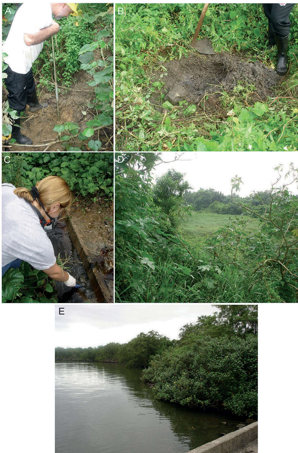
FIGURA 2 – (A) Perfuração de poço de monitoramento no ponto P3, (B) Material de cobertura do aterro: solo argiloso com entulho (S5), (C) Coleta de material lodoso com sedimento e líquido percolado do aterro em canaleta de drenagem (SD1, LP1), (D) Lagoa de líquido percolado do aterro, (E) Pier no limite norte da área, próximo ao ponto P3, com vista para o Canal de Piaçaguera e do mangue.
