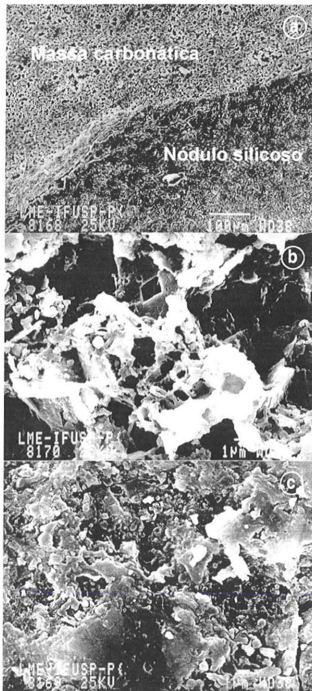
Figura 5 - Imagem de microscopia eletrônica de varredura de uma lâmina de calcário dolomítico silicificado após ataque com ácido clorídrico a 10% durante 24 horas na interface entre um nódulo silicoso e o remanescente de uma massa carbonática (a), detalhe do remanescente da massa carbonática (b) e detalhe do nódulo silicoso (c).
