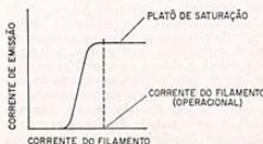
Fig. 3. Diagrama esquemático relacionando corrente de emissão e corrente do filamento. Para melhor performance e estabilidade, o revólver deve ser operado com a corrente do filamento atingindo o início do platô de saturação.
