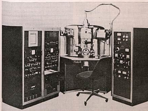
Fig. 2. Vista de um laboratório de microsonda eletrônica. O instrumento é um EMX-SM da Applied Research Laboratories. Da direita para esquerda: unidade geradora de energia; unidade espectrométrica com revólver eletrônico (tipo), lentes magnéticas, três espectrômetros, platina para amostra e microscópio óptico; sistema de amplificação com dois osciloscópios para o registro de imagens de varredura, parte eletrônica associada aos detectores, registro gráfico de dados etc. Equipamento similar acha-se em fase de instalação junto ao Instituto de Geociências da Universidade de São Paulo.
