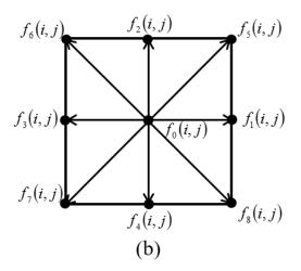
Figura 2: Estrutura de lattice D2Q9.
