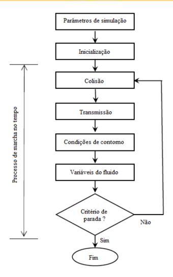
Figura 3: Diagrama de blocos do algoritmo computacional geral do método de LB.
