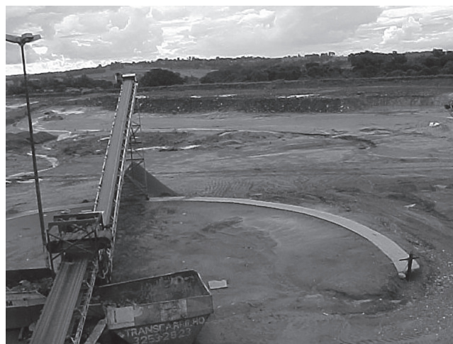
FIGURA 33.15 Homogeneizador de agregados reciclados (processo piloto) (à esquerda). Transportador de correia telescópico (à direita).
