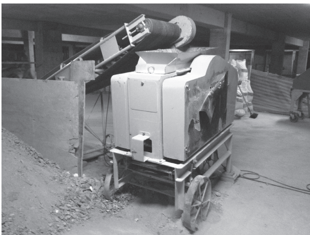
FIGURA 33.16 Moinho de martelo usado em uma obra.
