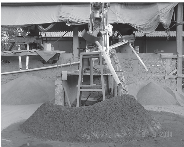
FIGURA 33.15 Homogeneizador de agregados reciclados (processo piloto) (à esquerda). Transportador de correia telescópico (à direita).
