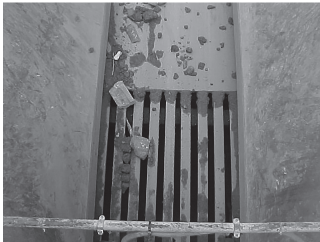
FIGURA 33.9 Alimentador vibratório (à esquerda) e escalpe (à direita).
