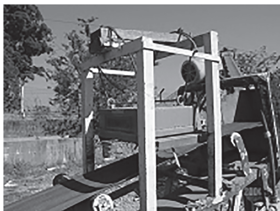
FIGURA 33.12 Separadores magnéticos suspensos e permanentes, de limpeza manual (à esquerda) e automática (à direita).
