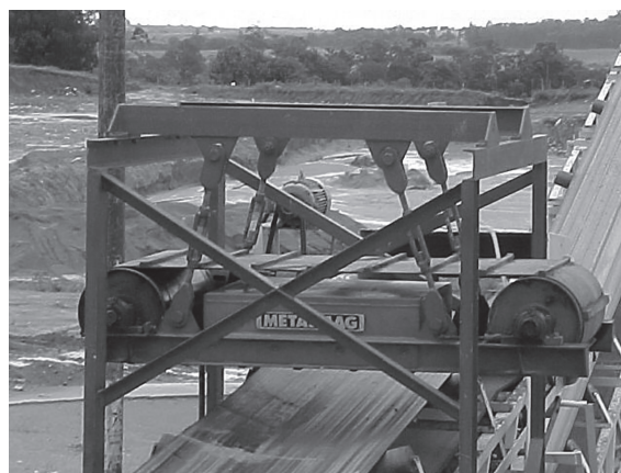
FIGURA 33.12 Separadores magnéticos suspensos e permanentes, de limpeza manual (à esquerda) e automática (à direita).
