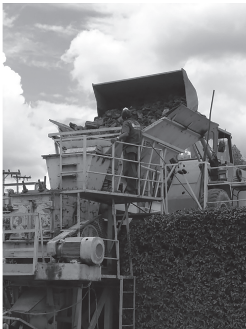
FIGURA 33.9 Alimentador vibratório (à esquerda) e escalpe (à direita).
