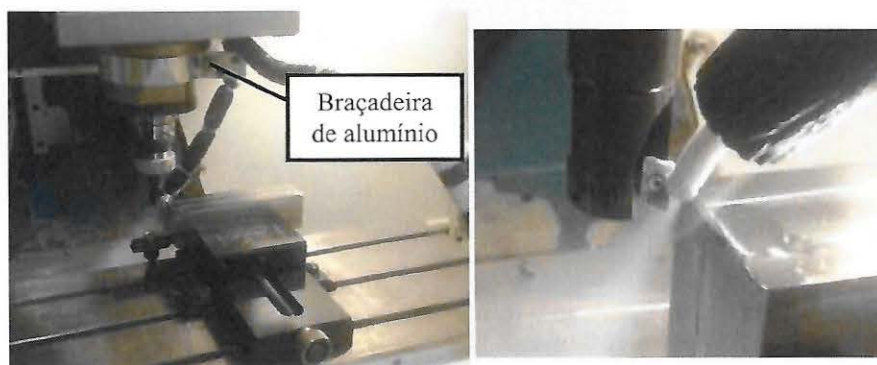
Figura 2. Montagem experimental dos ensaios de usinagem criogênica.
