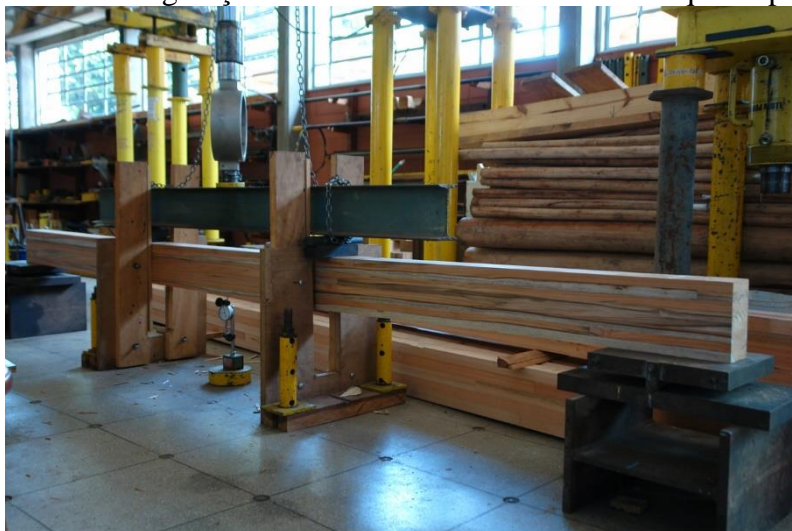
Figura 1 – Configuração do ensaio de flexão estática em quatro pontos
