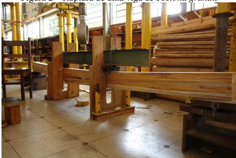
Figura 2 – Ruptura de uma viga de Tectona grandis
