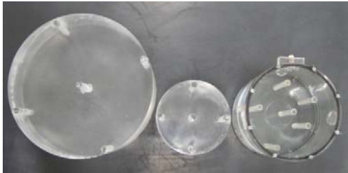
Figura 2 – Simulador para medições de dose da marca Nuclear Associates, modelos 76-414 (cabeça) e 76-415 (abdome) de acrílico sólido com espaços para medições na superfície e no centro e simulador de cabeça em acrílico e água produzido no IEE, respectivamente da esquerda para direita.
