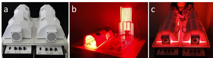
Figura 1. a) Imagem do dispositivo Kerato PDT explorando sua forma anatômica para acoplamento nos membros superiores, b) imagem evidenciando a disposição das placas de LED e c) paciente durante iluminação.
