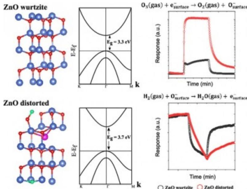
detecção de gases, o que pode auxiliar no desenvolvimento de sensores mais eficientes para detectar elementos como o ozônio.
