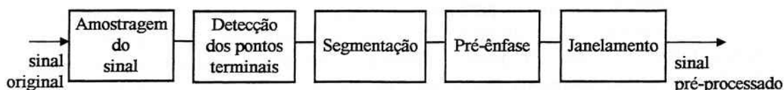
Fig. 4.1 - Pré-processamento dos sinais de voz utilizado no reconhecedor.
