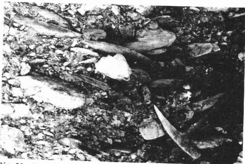
Fig.31- Detalhe da reorientação imposta aos seixos pelo efeito compressivo.
