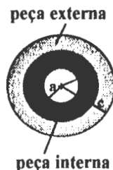
FIGURA 3.1 - Montagem forçada de duas peças cilíndricas.
