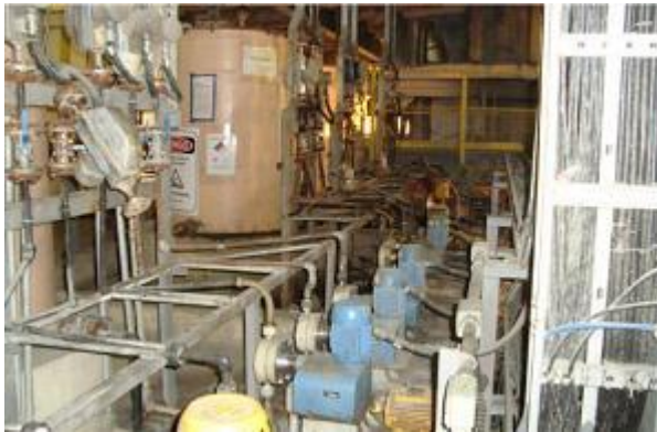
Figura 1. Sistema de dosagem de reagentes com bombas de diafragma
