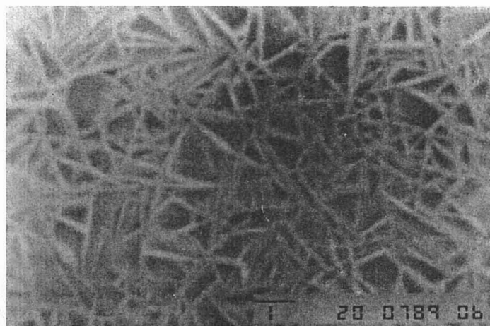
FOTO 2 — Região de poro do concreto celular autoclavado, caracterizada por cristais tabulares e alongados de tobermorita. (Aumento: 10000x)
