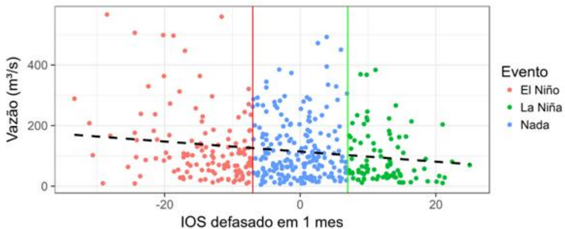
Figura B9 – Gráfico de dispersão entre Vazão e IOS no mês anterior.
