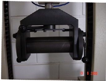
Figura 04: Vista do protótipo da garra já pronta e instalada
