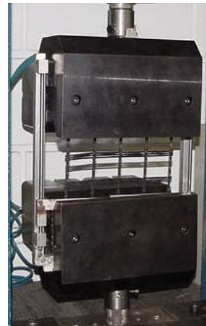
Figura 02: Exemplo de garra pneumática desenvolvida pela EMIC em parceria como LG-SGS.
