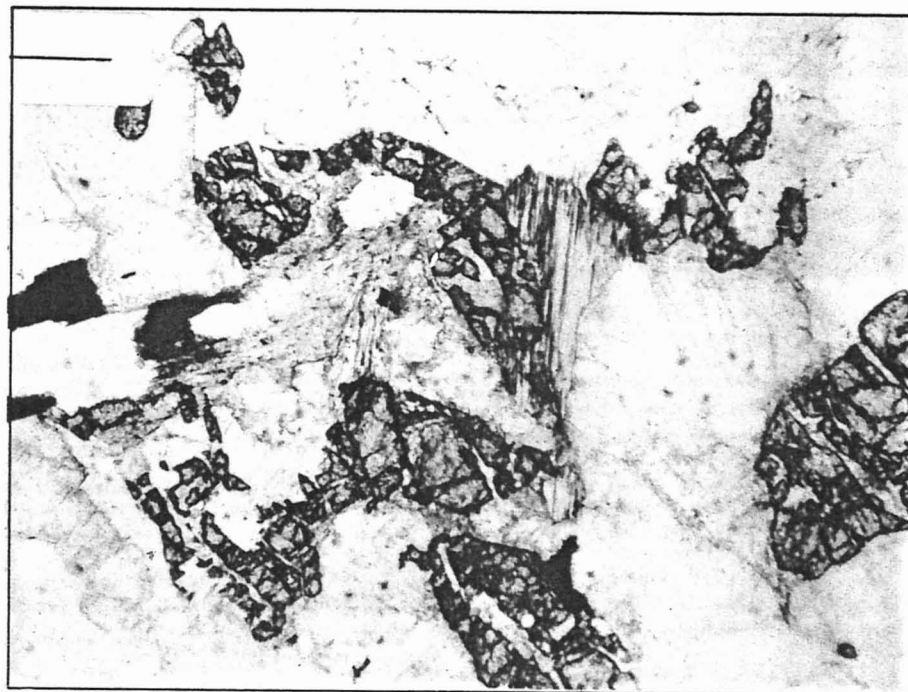
Fotomicrografia 1 — Grãos de granada corroídos e fraturados, com preenchimento de biotita verde e clorita. Amostra 5/2. Nicois paralelos. Escala: 500 \mu .
