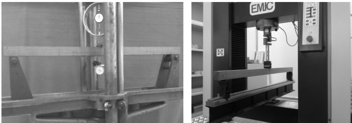
Figura 3- Ensaio de flexão estática a três pontos. a) AMSLER. b) EMIC.
