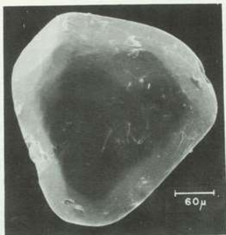
Fig. 2 - Micrografia Eletrônica. Cristal equidimensional de cromiopiro removido do interior do diamante mediante fragmentação. O abaulamento das faces e das arestas, bem como as cavidades do lado superior direito, são feições produzidas, provavelmente, por dissolução durante a cristalização das inclusões. As fraturas concentradas no lado esquerdo inferior produziram-se durante a fragmentação do hospedeiro. Aumento 250 \times .
