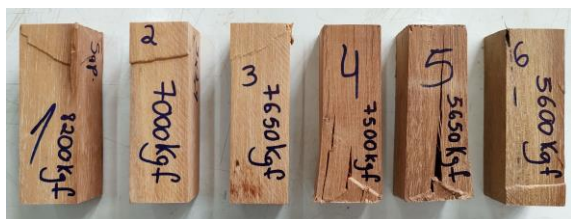
Figura 1: Corpos de prova rompidos da espécie da espécie Sapucaia ( Lecythis spp. ) de dimensão nominal de 3 cm x 3 cm x 9 cm.
