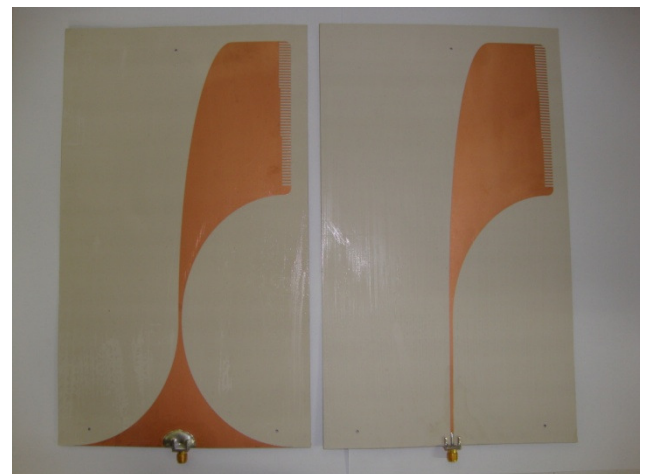
Figura 8. Antena Antipodal Vivaldi UWB corrugada fabricada
