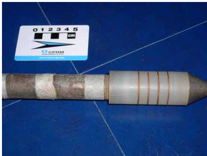
Figura 1 – Mini sonda de resistividade com arranjo Wenner
