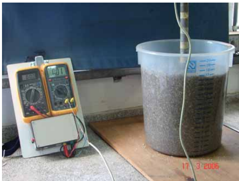
Figura 2 – Sistema completo, com a fonte de corrente, multímetros de leitura e sonda.
