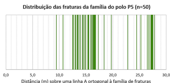
FIGURA 18 – Esquema das estruturas da família do polo P5 (em verde), indicando uma distribuição regularmente variável.
