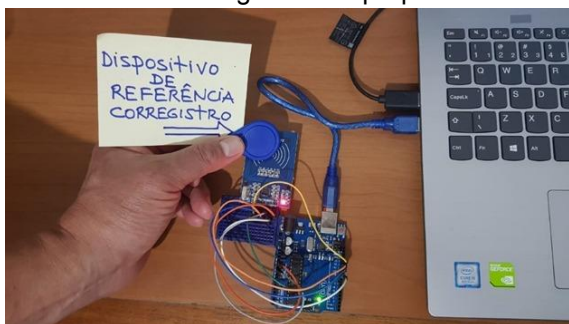
Figura 3: Aproximação da Tag imitando a presença de uma ferramenta de correção. Fonte: Própria.
