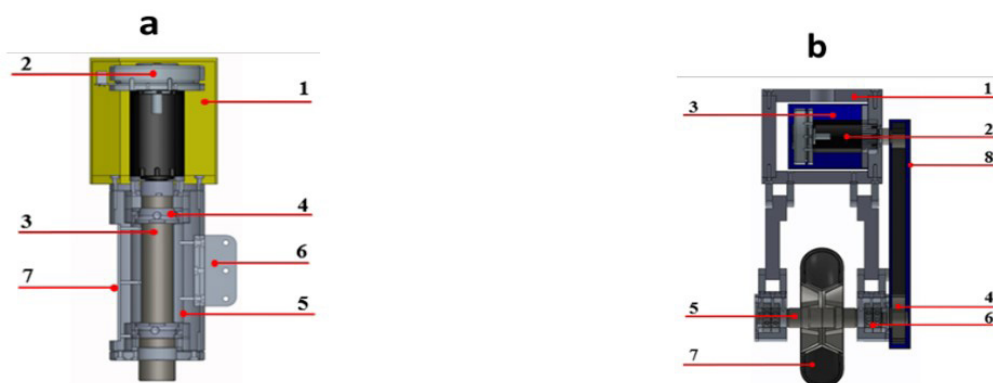
Figura 4. a) Componentes de direção do módulo das rodas, b) Componentes da propulsão do módulo das rodas.
