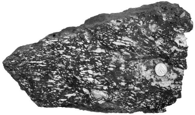
Figura 2 - Foto do dacito amigdaloidal portador de zeólita da Formação Serra Geral (Bacia Sedimentar do Paraná).
