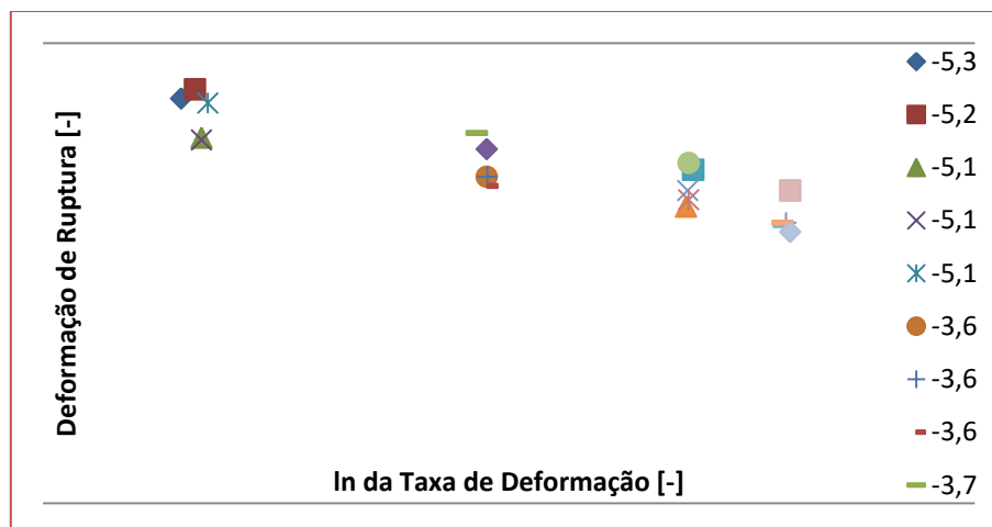
Figura 6 – Deformação de ruptura em função do logaritmo natural da taxa de deformação.
