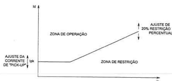
Figura 1 - Curva típica de um Relé Diferencial Percentual
