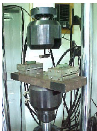
Fig. 4. Máquina universal preparada para el ensayo de flexión estática
