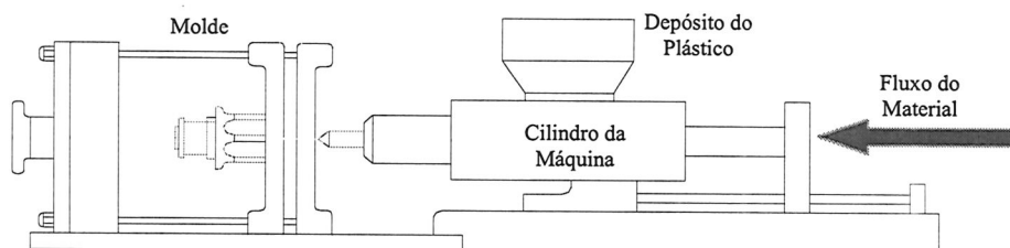
Figura 2. Processo de moldagem plástica por injeção.
