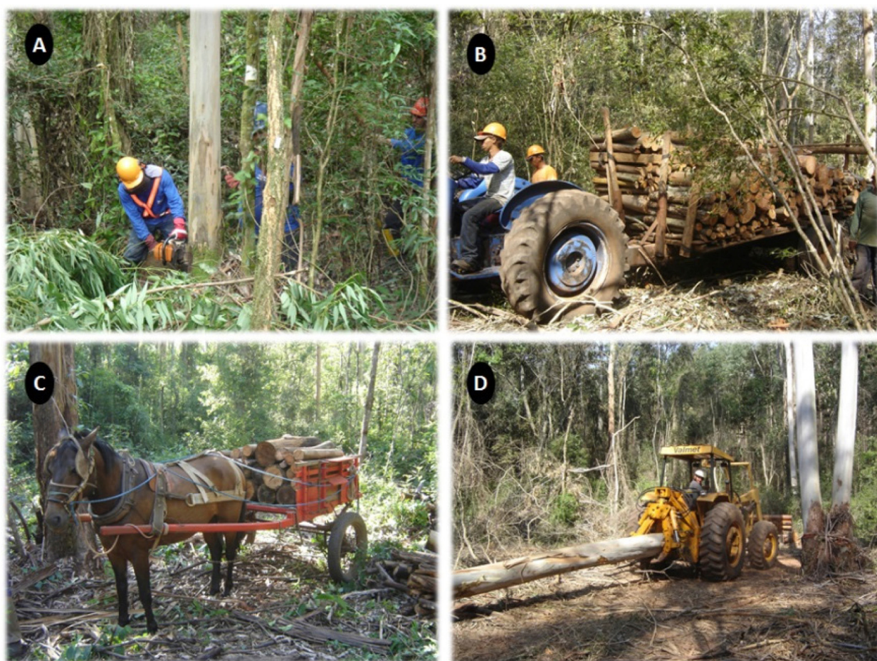
Figura 2. Modos de colheita florestal: (A) corte com motosserra; (B) extração mecanizada na etapa 1 (colheita de lenha); (C) extração com animal na etapa 1 (colheita de lenha); (D) extração mecanizada na etapa 2 (colheita de tora).
