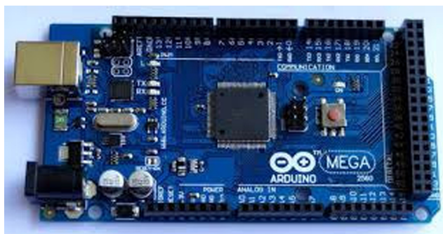
Figura 9: Plataforma Arduino, modelo MEGA 2560, utilizado na aquisição e no processamento dos valores de corrente, tensão, velocidade, massa final e características magnéticas das bobinas.
