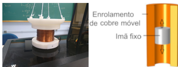
Figura 8: Bobina com 750 espiras com a disposição do ímã fixo, a bobina possui movimento livre sobre um eixo vertical (haste) que fixa o ímã.
