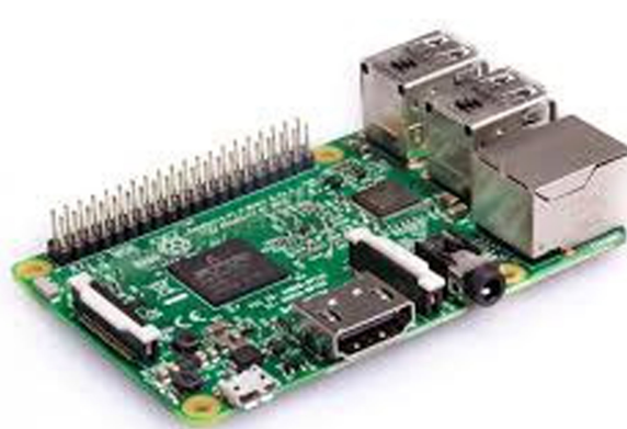
Figura 10: Raspberry Pi 3 utilizado como computador de visualização dos dados, o Arduino comunica-se com este embarcado via comunicação serial.
