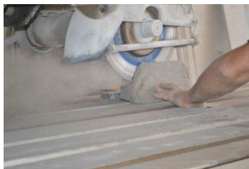
Figura 8. Tentativas de corte a seco realizadas em marmoraria. Notar a poeira gerada no corte, além da insuficiência de altura para cortes em razão do diâmetro usual das serras diamantadas.
