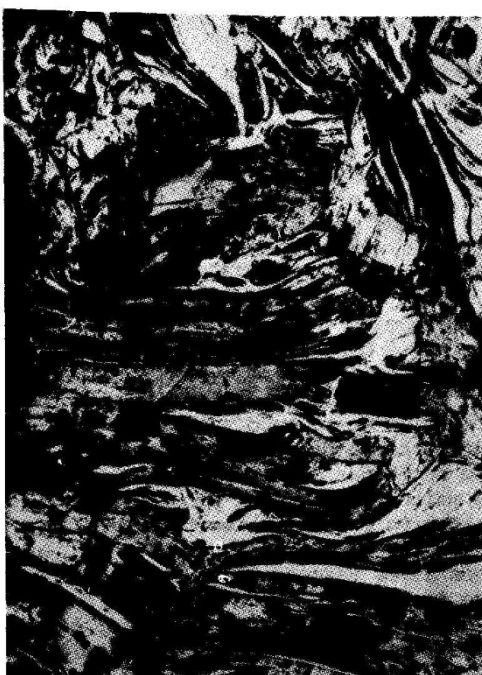
FOTO 1 - Criptomelana granoblástica. Polarizadores semi-cruzados. (X45); FOTO 2 - Criptomelana granoblástica, com planos reliquiais de geminação. Óxidos secundários de manganês precipitam-se nos interstícios granulares. Polarizadores descruzados. (X35); FOTO 3 - In-tercrescimento epitaxial entre grafita (preto) e litioforita (cinza), perturbado por penetrações de criptomelanas (branco) nas bor-das e extremidades do conjunto. Polarizadores descruzados. (X35); FOTO 4 - Criptomelana colofome ou maciça que perturbou as antigas lamelas grafita-litioforita e substituiu totalmente esta última. Polarizadores descruzados. (X35).
