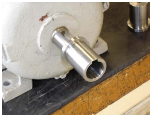
Figura 12.2: Bucha interna da roda, já fixada ao eixo do motor.
