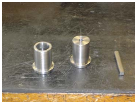
Figura 12.1: Buchas da roda e chaveta de fixação.
