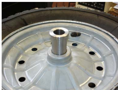
Figura 12.4: Bucha externa entrando para prensar a roda, fixando-a.
