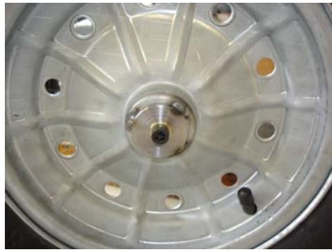
Figura 12.5: Roda já fixada, com auxílio do parafuso e pontos de solda.
