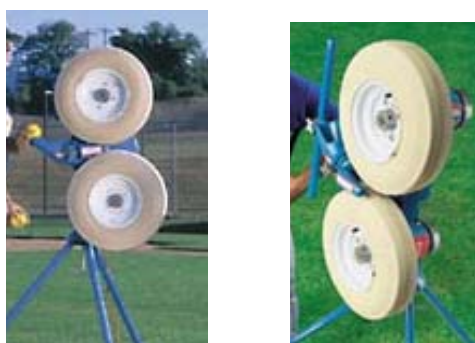
Figura 1.1: Exemplo de uma máquina arremessadora com sistema de lançamento por rolos.
