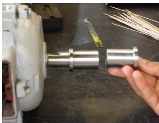
Figura 12.3: Buchas que se contrapõem, prensando a roda, e mantendo-a fixa.
