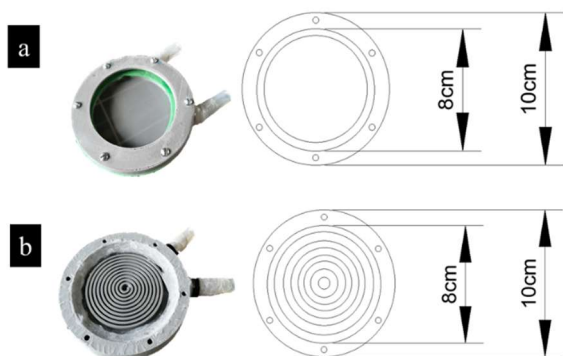
Figura 2. Design dos reatores. a) Reator plano; b) Reator caracol.
